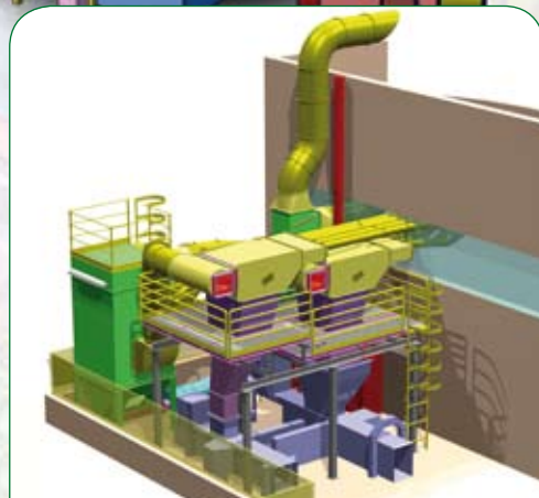
Stazione di scarico 20.000 m 3 /h per due prodotti Discharge system 20.000 m 3 /h for two products
